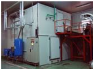
PR Freeze - Kontinualni tunel za duboko zamrzavanje Montiran u hladnjači "Libertas" Šabac Srbija Kapacitet: 5.000 kg/h (na bazi graška)
